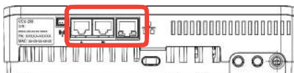
Centrālā vadības bloka apakšpuse, ar RJ45 pieslēgvietām skārienekrāna/datora pievienošanai un LAN savienojuma izveidošanai.
